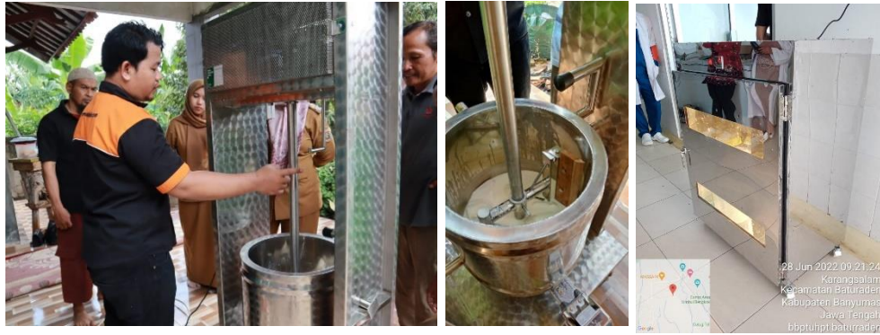
Gambar 25. Mesin pengaduk susu di Lampung dan Inkubator yogurt dan Mesin Filling botol di BBPTU Baturaden
